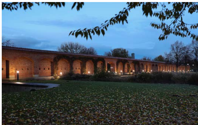
Abb.: Die warmweiße Lichtfarbe mit 2.700 K ist insektenfreundlich und selbst die Schockbeleuchtung für die Polizei – üblich in kaltweißer Lichtfarbe – besitzt 3.000 K.
